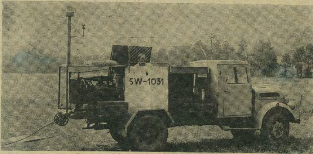
Die Motorwinde: mit ihr werden die Segelflugzeuge hochgezogen.
